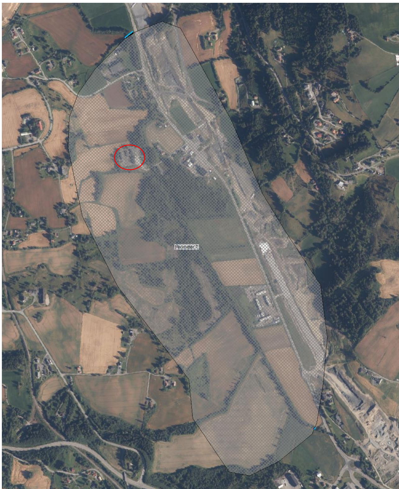
Figur 6. Utstrekningen til modellen er vist med grå skravur. Tiltaksområdet er markert i rødt. Innløp og utløp i modellen er vist med blå streker.
