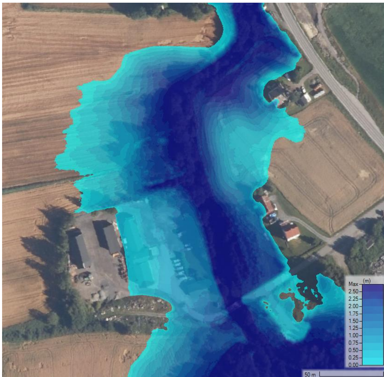
Figur 14 Beregnet flomsone (og vanndybde i m.) for tiltaksområdet. 200-årsflom med klima- og sikkerhetspåslag.
